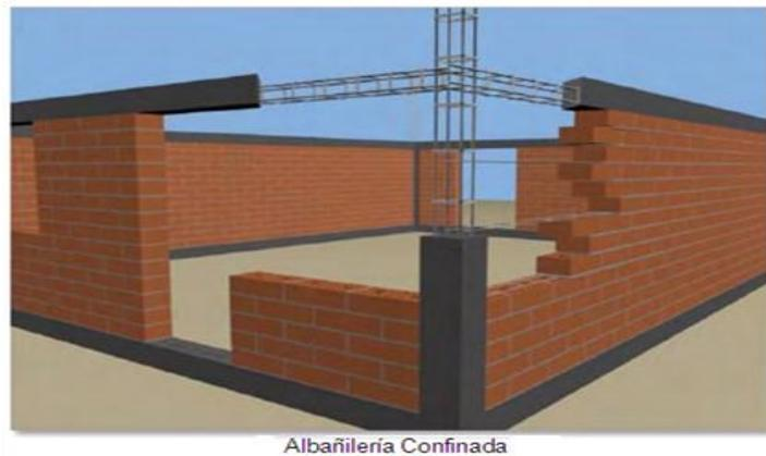
Figura 03. Estructura de albañilería confinada
