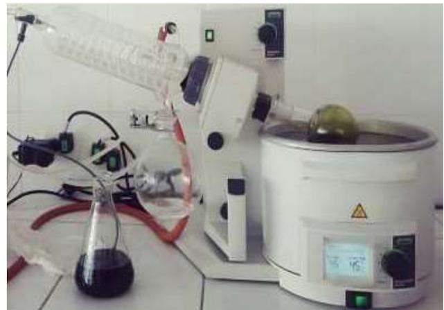
**Imagen 8:** Colocar los 20 mL del filtrado en el rotavapor por 2 horas para obtener una muestra semi sólida, la cual se obtuvo 18 mL.
