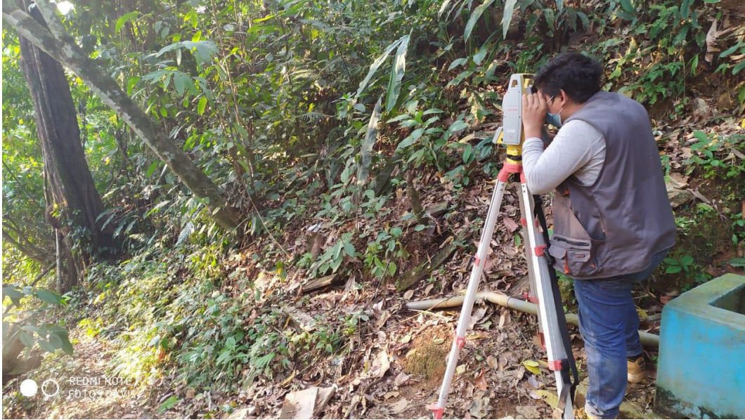
Figura 30. levantamiento topográfico de línea de conducción
