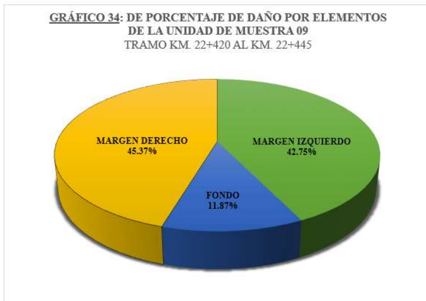
Descripción del Gráfico 34: Porcentaje de daño por elementos de la Unidad de Muestra N° 09
