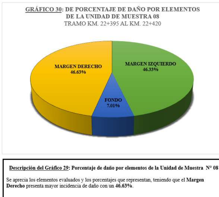
Gráfico 30: Porcentaje de la evaluación de daño por elementos de la U.M. 08
