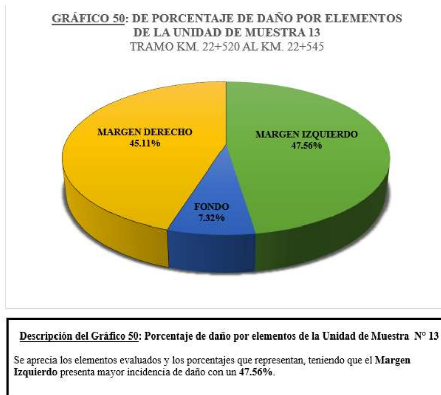
Gráfico 50: Porcentaje de la evaluación de daño por elementos de la U.M. 13
