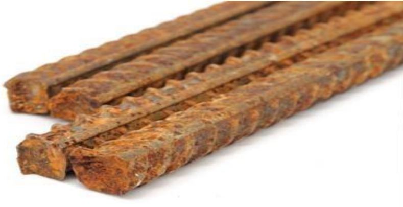
Figura 13. Aceros oxidados. Fuente: Elaboración propia.
