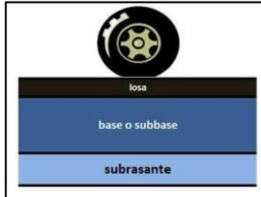
Figura 2. Composición de un pavimento rígido Fuente: (Rodríguez Velásquez, 2009).
