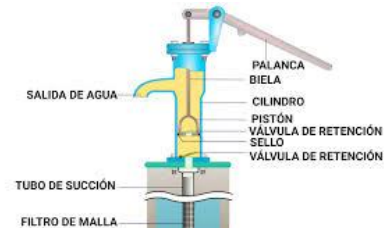
Gráfico 6: Pozo con Bomba manual
