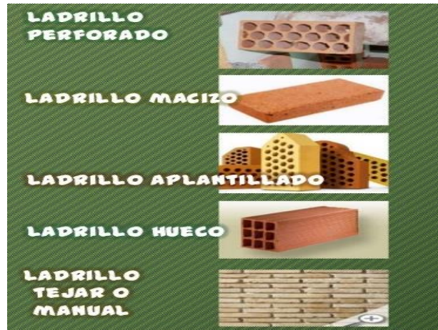
Imagen N° 11: Ladrillos en albañilería confinada. (Rojas R.)
