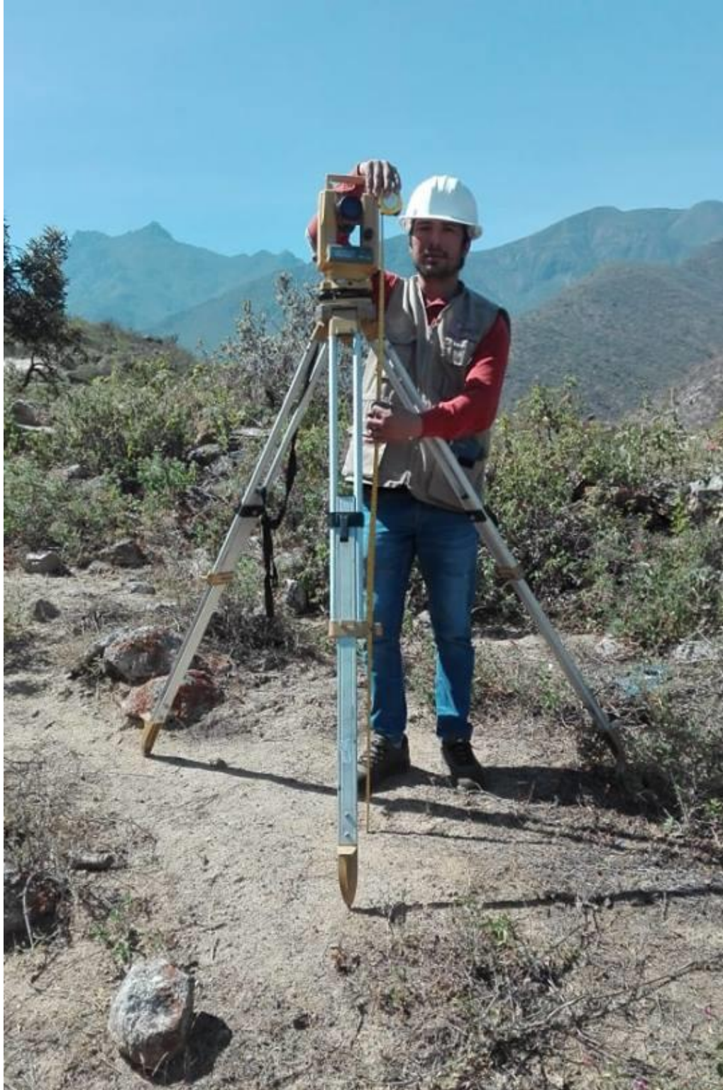
Figura N° 23: Tomando la medida del hilo del instrumento para realizar el levantamiento topográfico en la línea de conducción.
