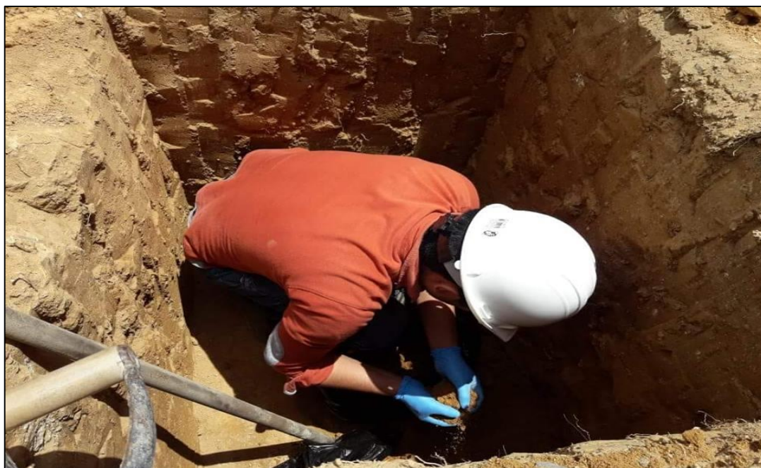
Figura N° 18: Se procedió a recoger la muestra de la línea de conducción en envases respectivos (bolsas de plástico) para mantener su estado natural.
