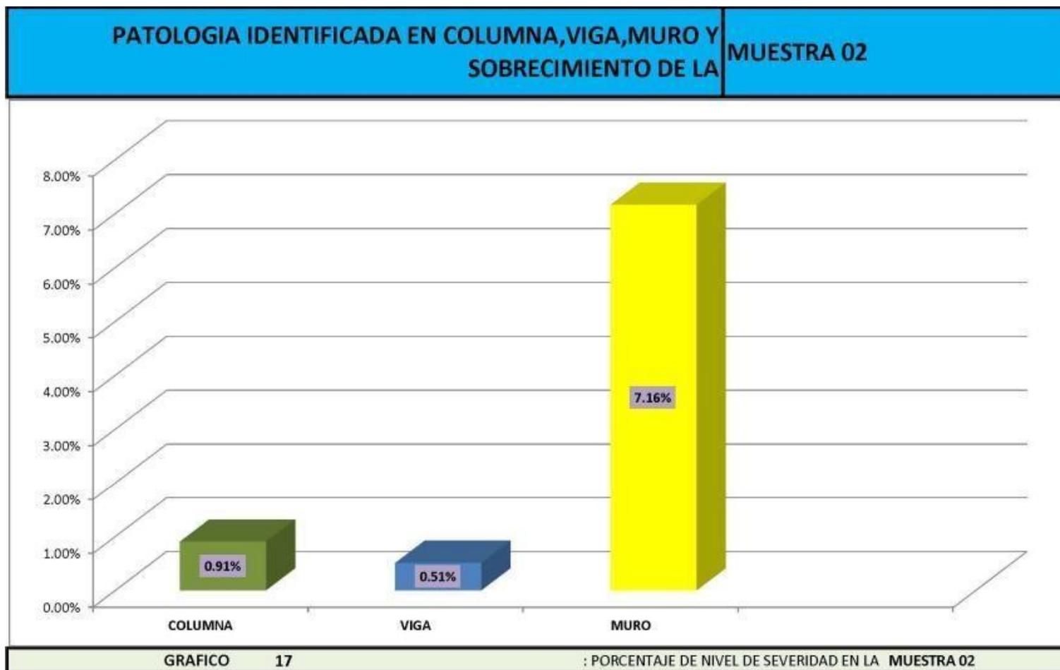
Figura 17: porcentaje de patología en columna, viga, muro y sobre cimiento en la muestra 02
