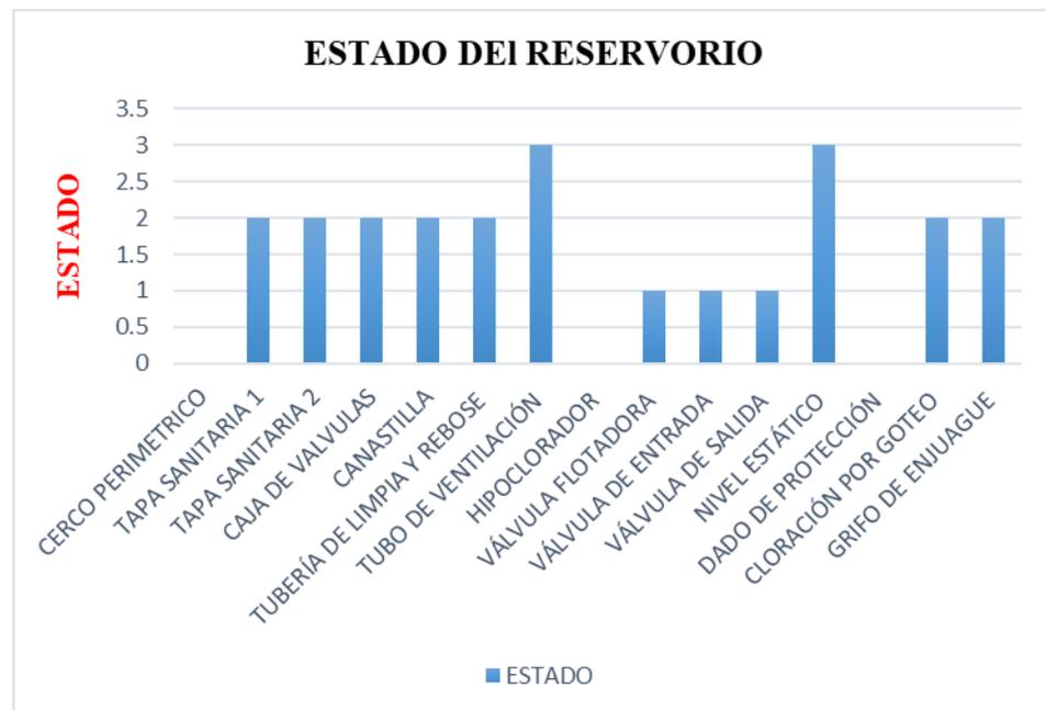
**Figura 18:** Diagnostico del reservorio
