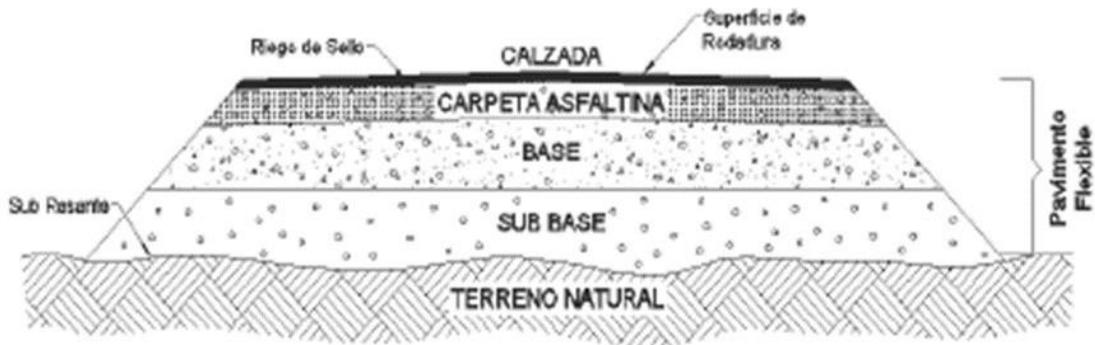
Figura. 2.3: Sección típica del pavimento flexible y sus partes. Fuente: Adaptado de Montejo, 2010.
