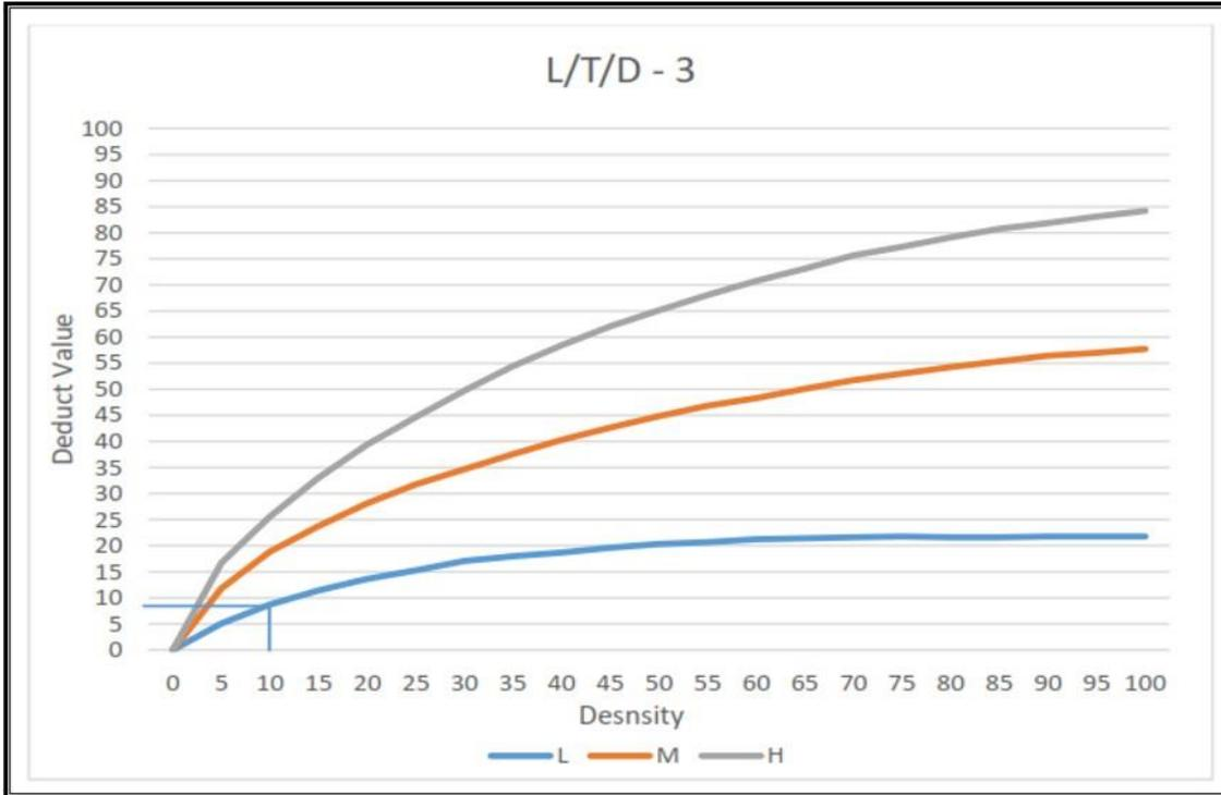
Figura 2.23: Valores de grieta longitudinal y transversal para el cálculo de DVs. Fuente: (Invias, 2006).
