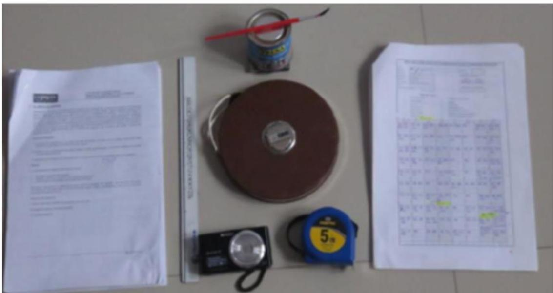
Figura 17: Equipos y materiales usados para la Inspección visual
