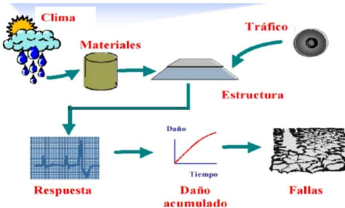
Figura 2.15: Efectos del Clima y el Tráfico en el Comportamiento de Pavimento. Fuente: Adaptado de Montejo, 2010.
