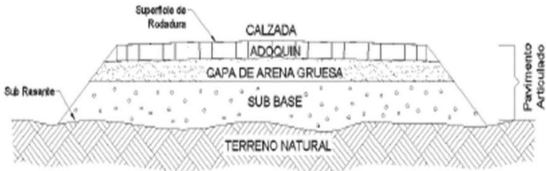
Figura 2.8: Sección típica de pavimento articulado y sus partes. Fuente: Adaptado deMontejo, 2010.
