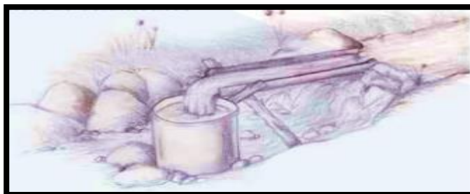
Ilustración 5: Medición del caudal por el método volumétrico
