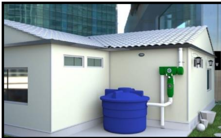
Ilustración 4: Captación de agua pluvial
