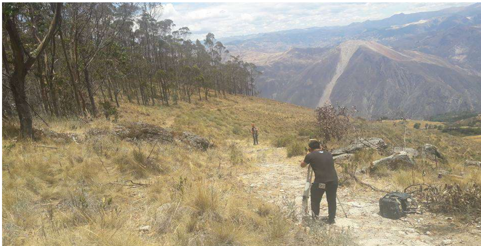
Imagen 5: Levantamiento con Estación Total en el Caserío de Shullugay.
