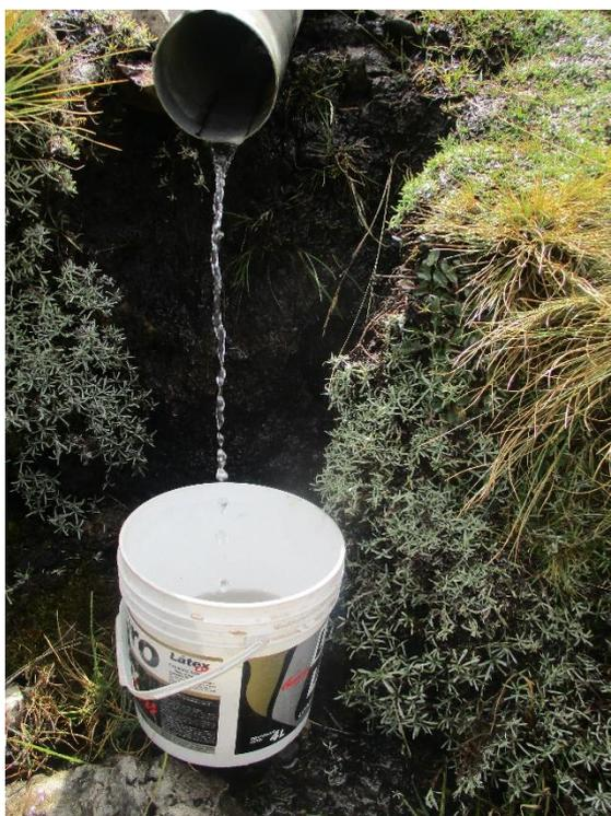
Fotografía N° 02: Se observa el momento donde se está aforando una de los manantiales.
