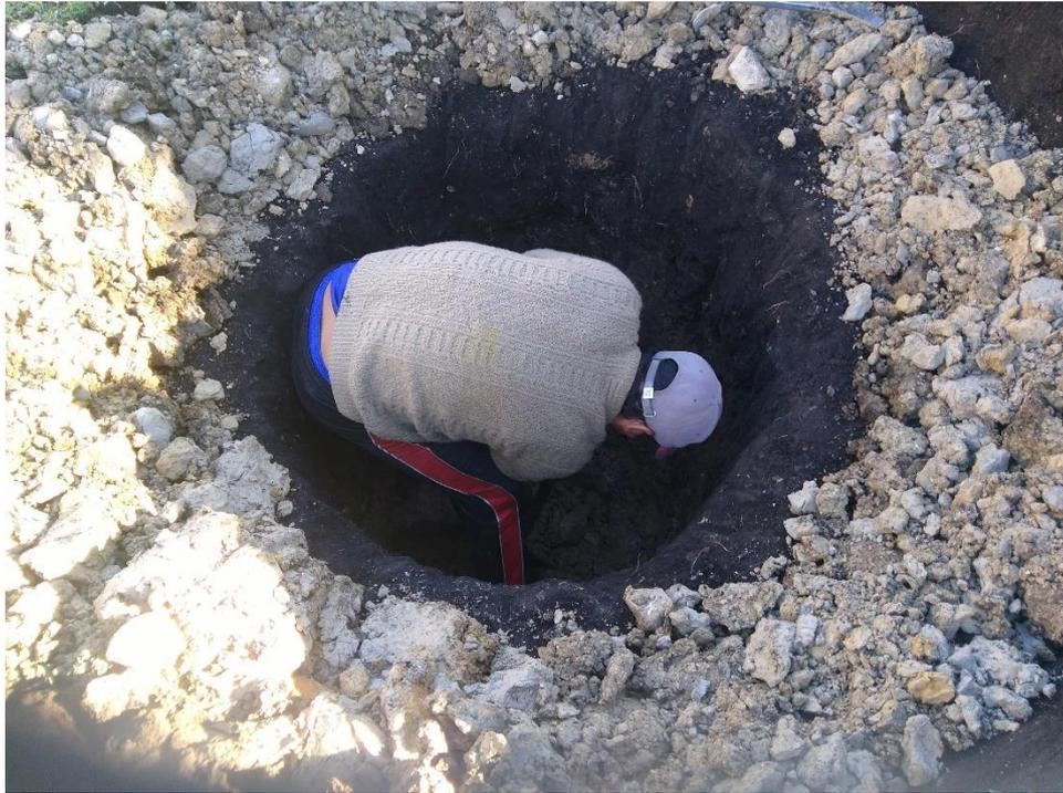
Fotografía N° 05: En la fotografía se observa el momento en que se esta realizando la calicata, para el análisis de suelo correspondiente.
