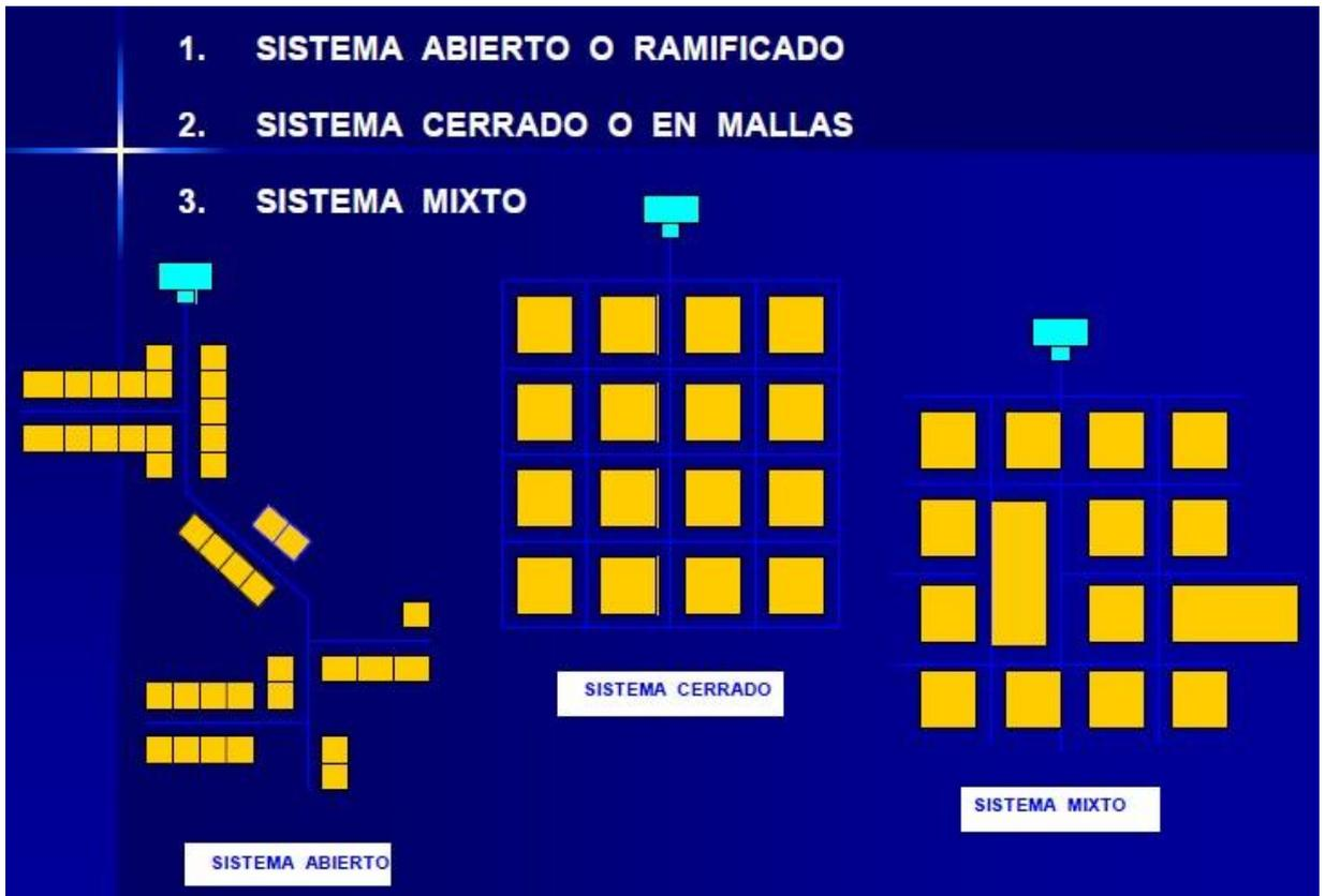
*Figura 11. Sistema de distribución del agua potable*
