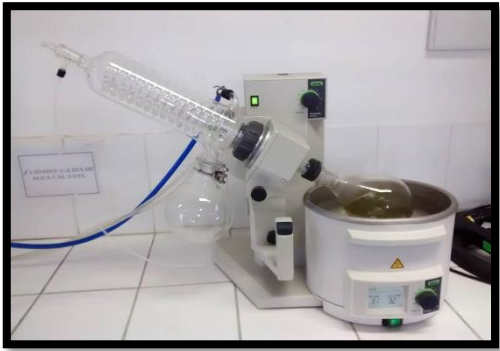
Concentración del extracto etanólico de semilla de palta en el equipo rotavapor 40°C
