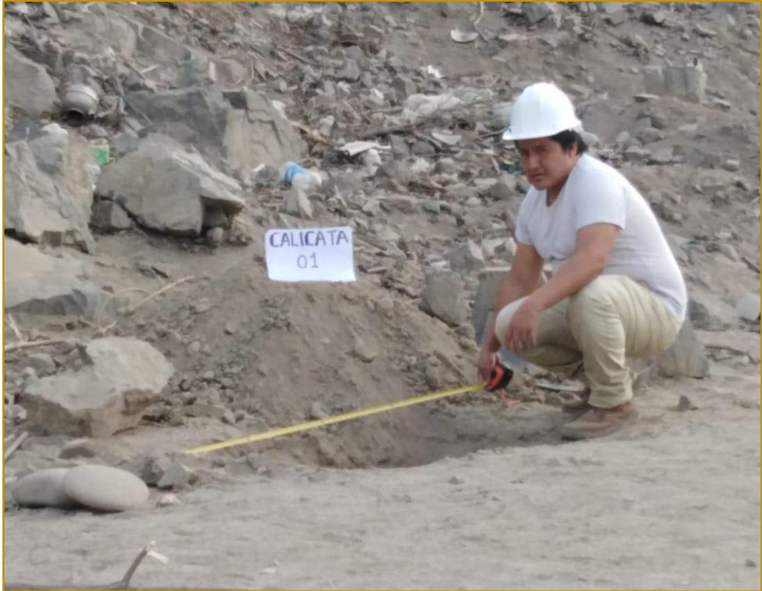
Fotografía 8: Realizando Calicata a exploración en cielo abierto
