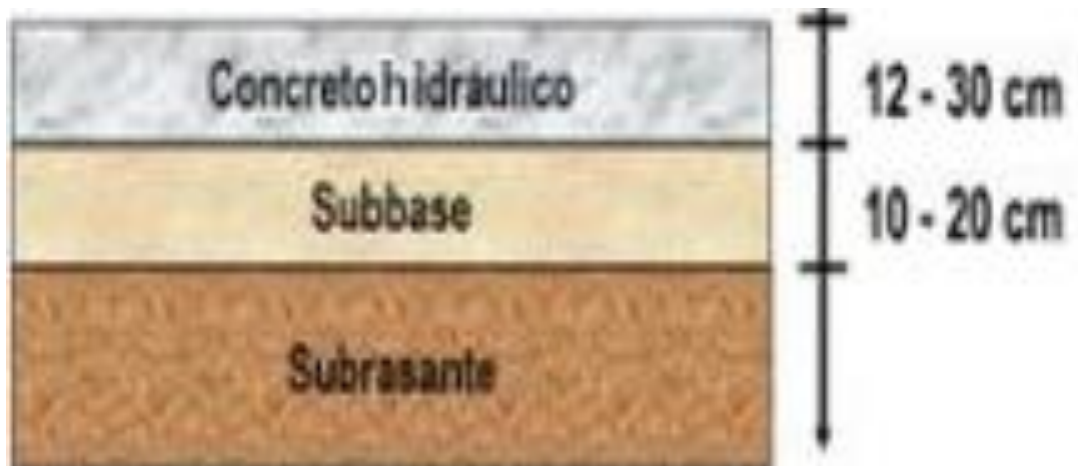
Figura 3 :Capas del pavimento rígido y la dilatación.
