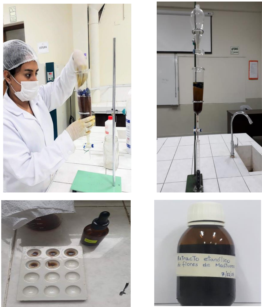
Figura 06: Armado del percolado y humectación por 48 horas
