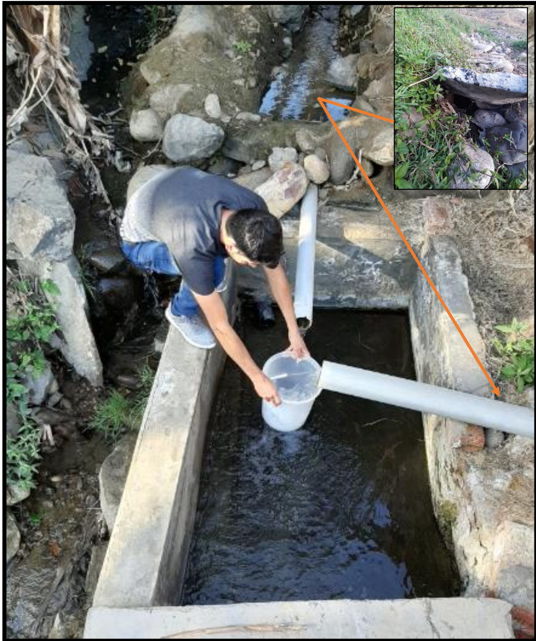
Fotografía 4: Medición del caudal de la captación de ladera y concentrado en un balde (10 L) para el método volumétrico.
