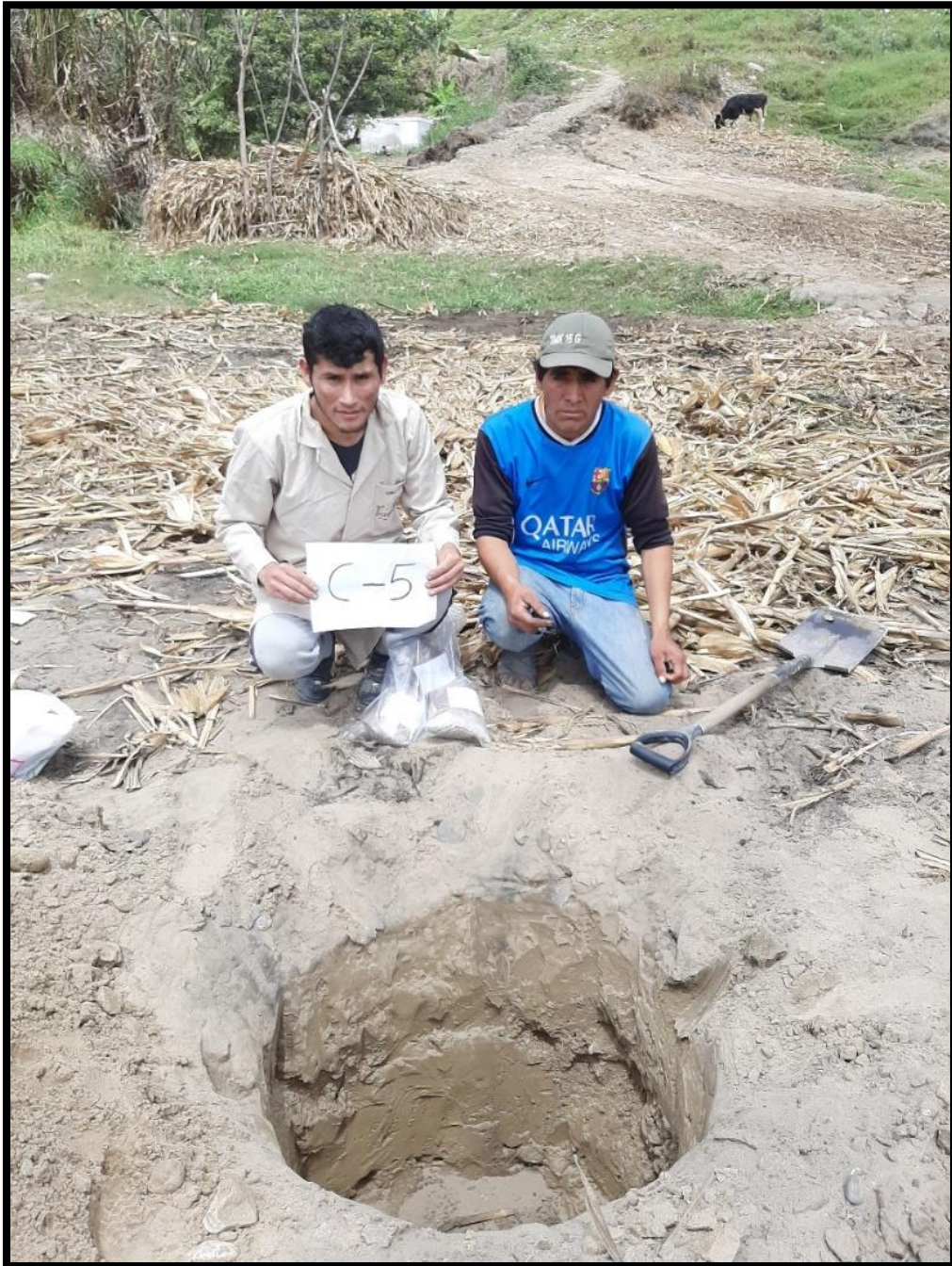
Fotografía 8: Toma de muestras de los estratos del suelo para la captación y el reservorio en donde será colocado el reservorio de almacenamiento en el centro poblado El kilómetro 24 Pampa de Vinzos. Fuente: Elaboración propia (2019).
