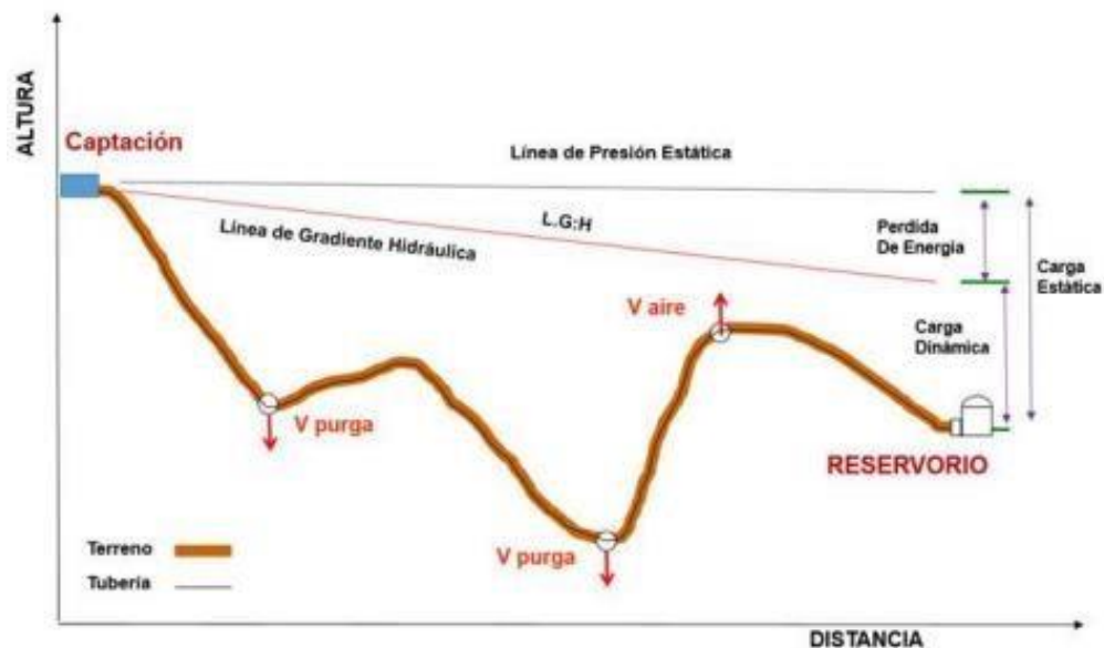
Figura 11: Cargas estática y dinámica de la línea de conducción.
