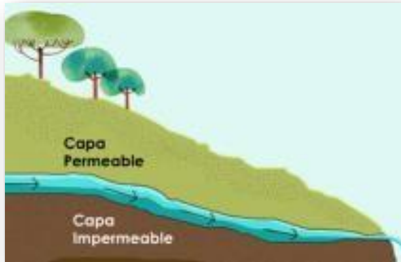
Figura 03: Manantial de ladera.
