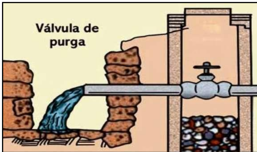
Ilustración 13. Vista de perfil de válvula de purga.
