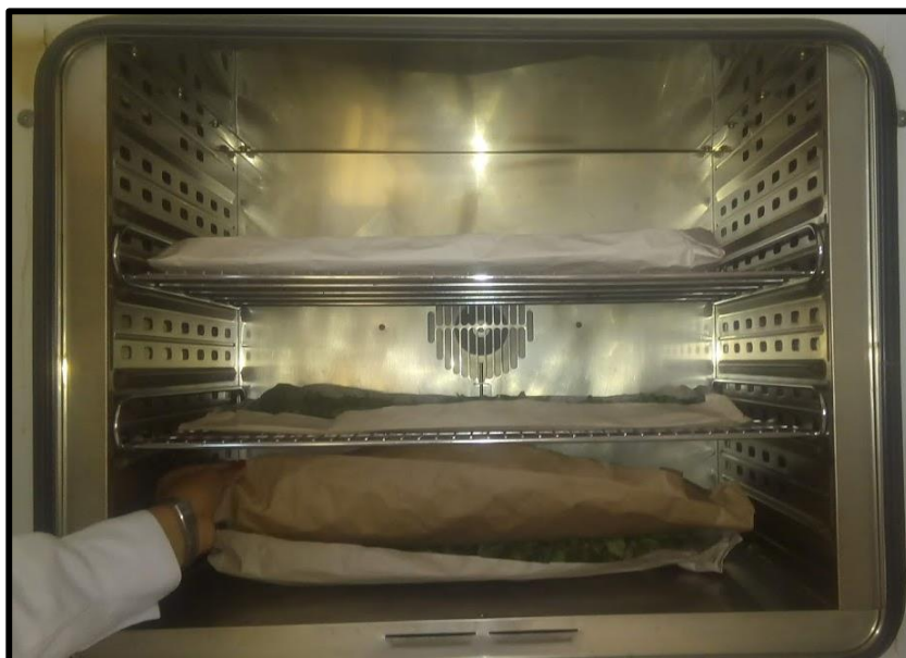
Imagen 2: Secar la muestra para proceder a secar en estufa a 55°C por 2 días.
