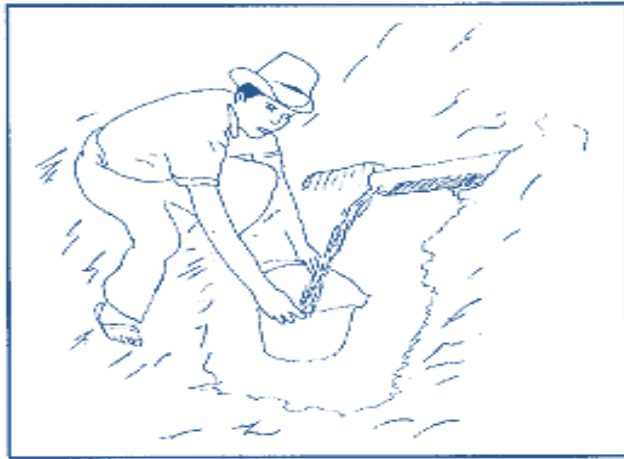
Figura 4. Medición del caudal por el método volumétrico.
