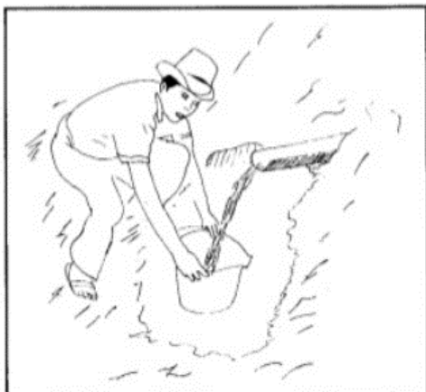
Figura 3.6 : Aforo del agua por el método volumétrico
