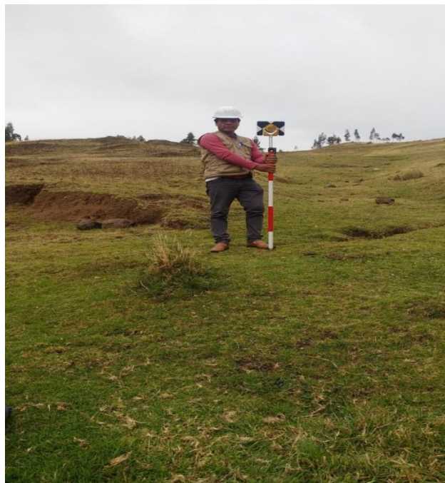
Fotos 04. Recolectando datos para el levantamiento topográfico.
