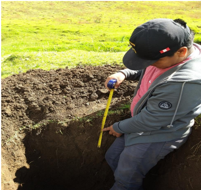
Fotos 09 y 10: Medición de las calicatas para para sus respectivos estudios de suelos.
