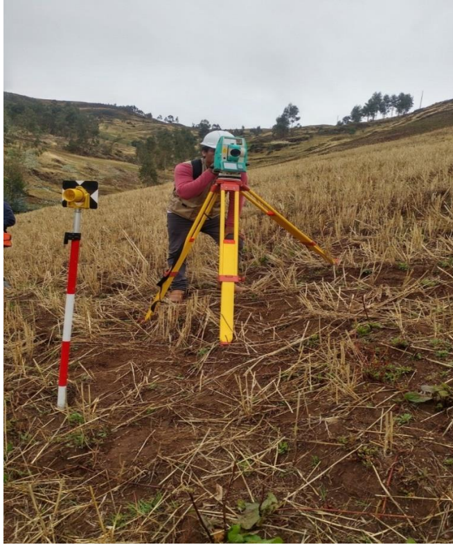
Fotos 05. Recolectando datos para el levantamiento topográfico.
