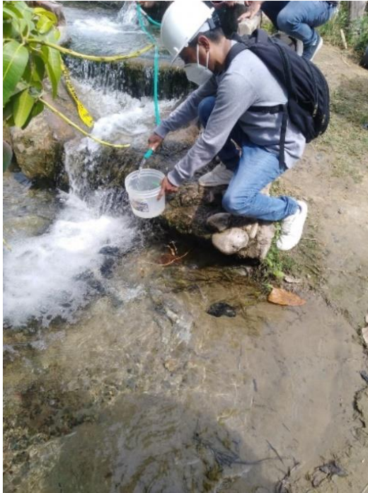
Gráfico 13: Medición de recipiente y encausado del agua del manantial
