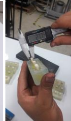
Piezas dentarias cementadas por grupo de estudio en bloques de acrílico
