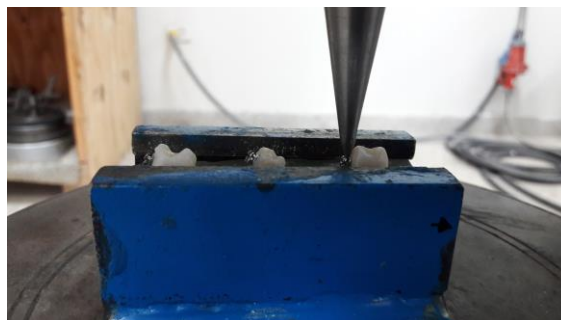
Ejerciendo cizallamiento de brackets para medir la fuerza de adhesión
