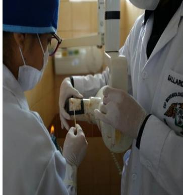
Toma de muestra del cabezal de rayos X usando una plantilla de 5cm x 5cm y un hisopo estéril embebido en una solución estéril de NaCl al 0.9%.
