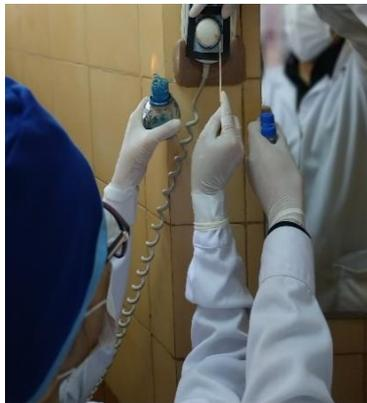
Toma de muestra del diparador de rayos X usando una plantilla de 5cm x 5cm y un hisopo estéril embebido en una solución estéril de NaCl al 0.9%.
