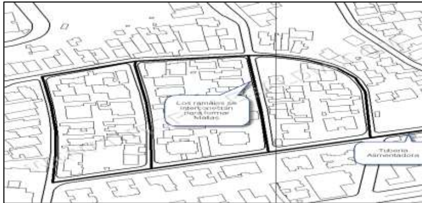
Figura 10. Esquema de una red de distribución de agua potable cerrada o malladas.
