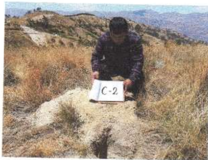
En la presente imagen se aprecia las aperturas de las calicatas para la toma de muestra.
