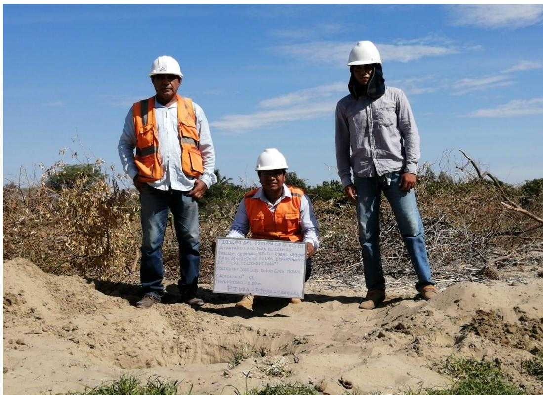
Imagen 4: Calicata N° 1 a cielo abierto de profundidad 1.50 m.
