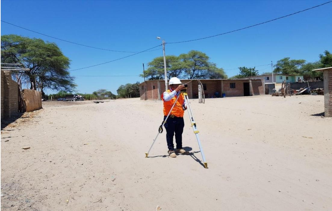
Imagen 2: Determinación de cotas y ejes de terreno natural
