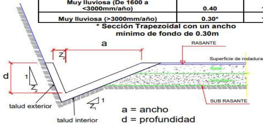
Imagen N° 02: Dimensiones mínimas de cuneta triangular típica.
