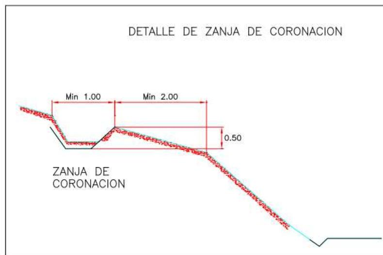
Imagen N° 03: Detalle típico de zanja de coronación.
