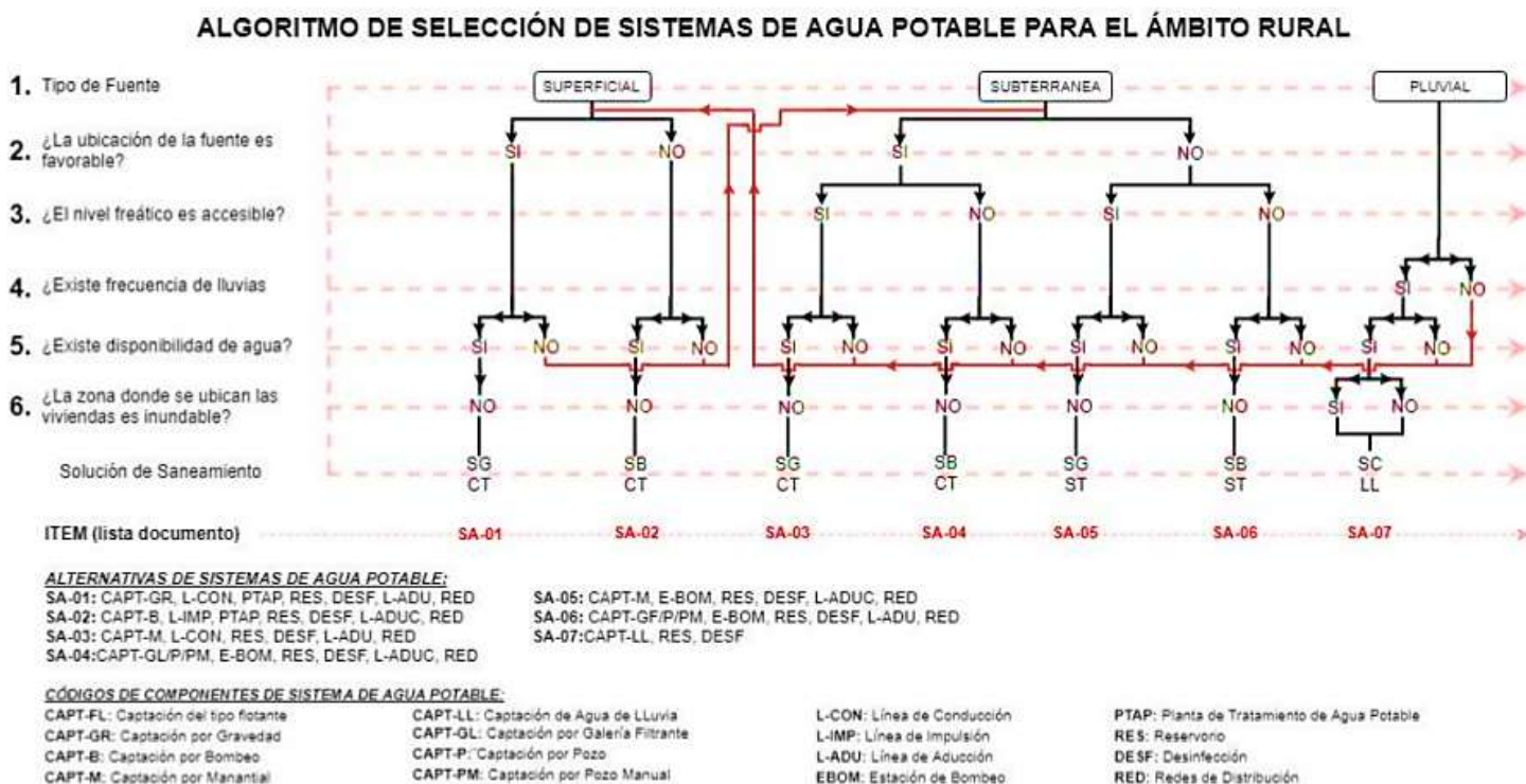
IMAGEN N° 1: Algoritmo de selección de sistemas de agua potable para el ámbito rural.
