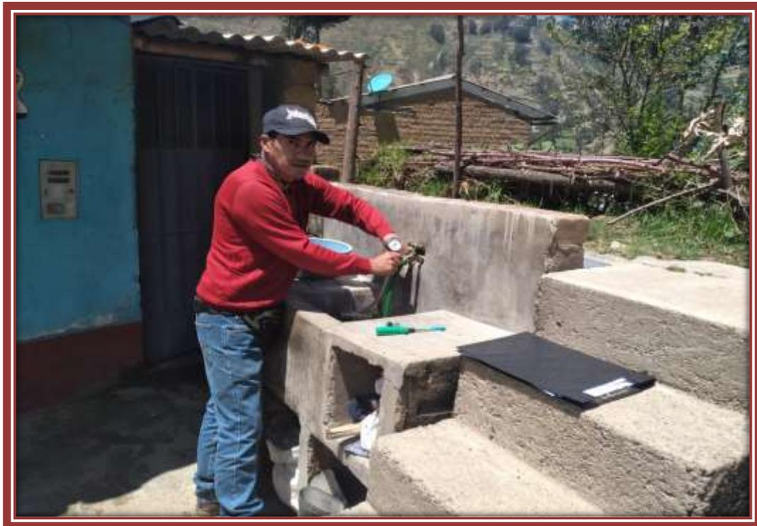
Fotografía 41: Medición de la presión en viviendas intermedias.
