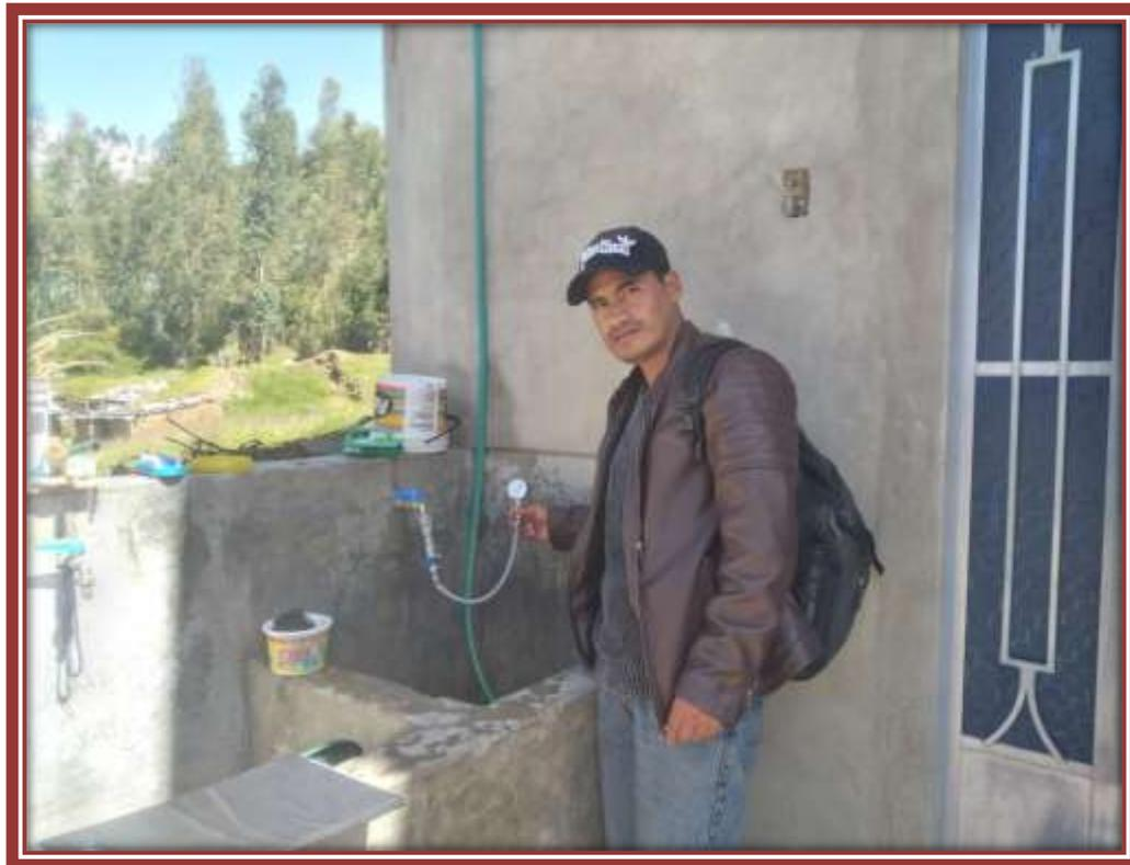
Fotografía 42: Medición de la presión en ultimas viviendas
