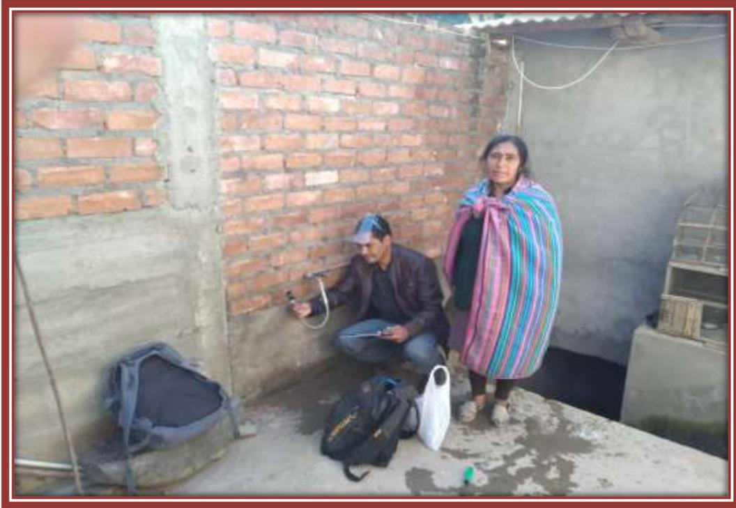
Fotografía 39: Medición de la presión en viviendas cercanas al reservorio.
