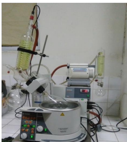
Equipo de rotavapor que se utilizó para eliminar el solvente de los extractos hidroetanólicos de Foeniculum Vulgare (hinojo)
