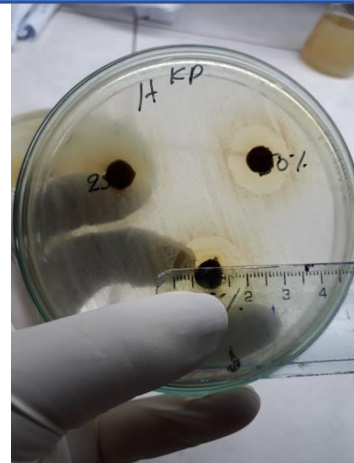
Medir el diámetro de los halos de Inhibición Foeniculum vulgare M. (hinojo)
