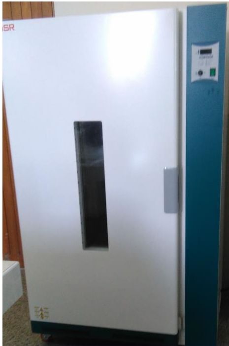
Estufa con circulación de aire forzado a 40°C
