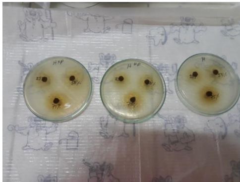
Medir el diámetro de los halos de Inhibición Foeniculum vulgare M. (hinojo)
