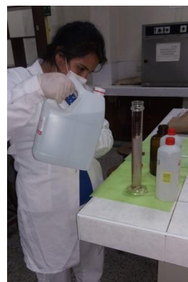
Mezcla de Alcohol 96° con Agua Destilada (etanol al 70°)
