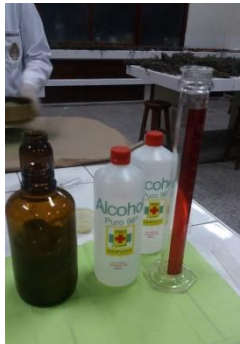
Mezcla de Alcohol 96° con Agua Destilada (etanol al 70°)
