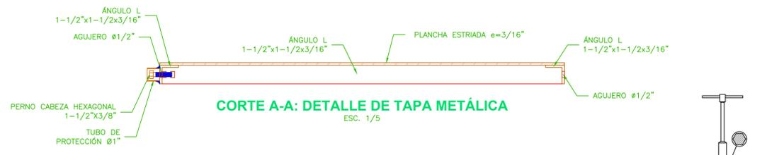
**CORTE A-A: DETALLE DE TAPA METÁLICA**
