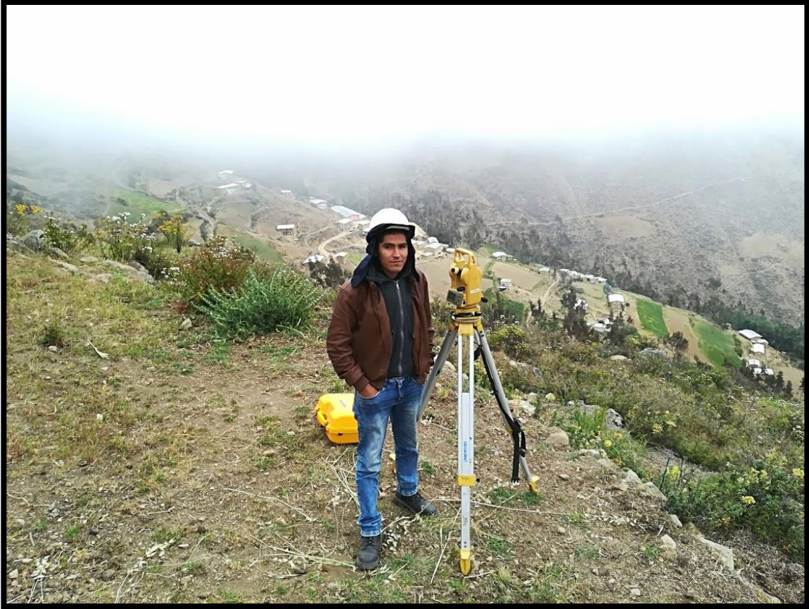
Imagen 05: realizando la topografía del sistema de abastecimiento de agua potable del caserío de huanca.
