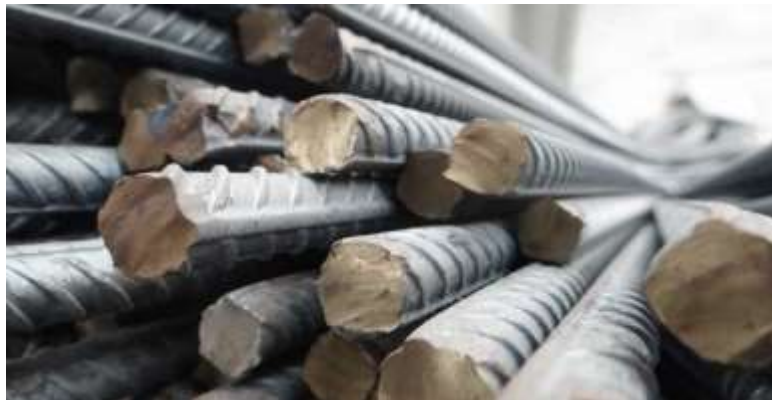
Figura 17: Varillas de acero.
