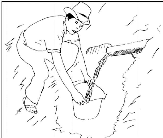
Figura 6: Aforo del agua por el método volumétrico
