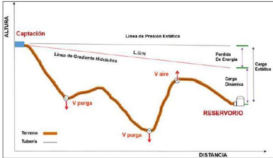
Figura 7: Esquema de la Línea de Conducción
