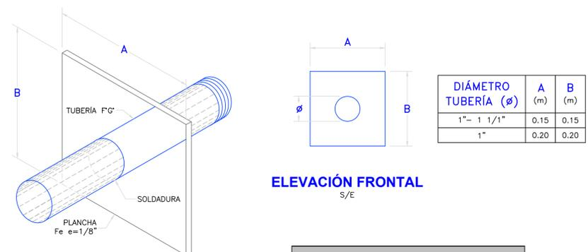
**Tubería Galvanizada F"G" Serie I - Standart - Recubrimiento galvanizado (Diámetros y espesores según Norma ISO 65) L= 6.40 m Extremos roscados NPT ASME B1.20.1**
