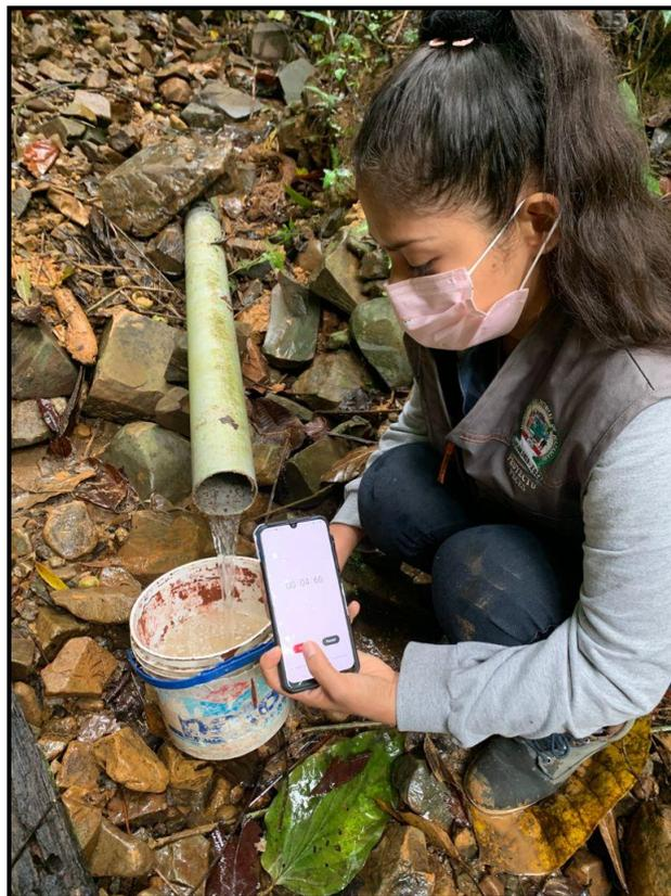
**Figura 33:** Medición con cronometro para determinar el caudal
