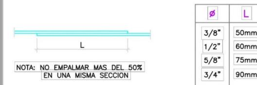
NOTA: NO EMPALMAR MAS DEL 50% EN UNA MISMA SECCION
