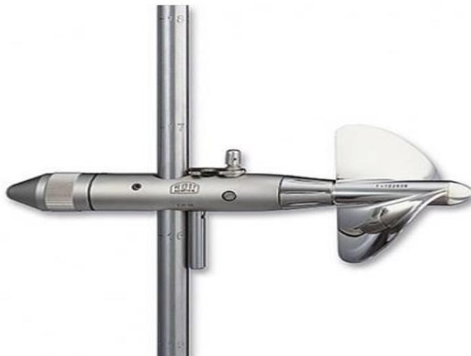
Figura 15. Correntómetro o molinete.
