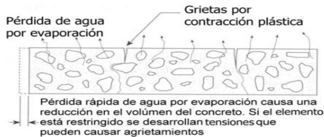
Figura 23. Esquema de contracción por secado en el concreto.
