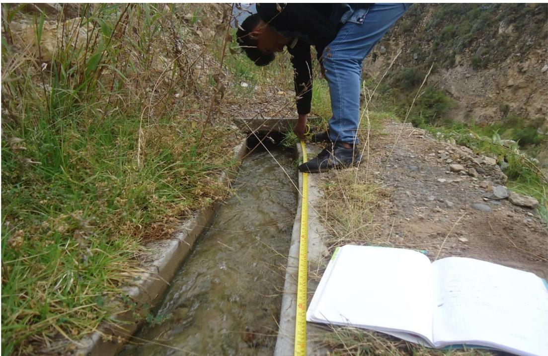
*Figura 37.* Canal de riego Potrero - Medición de Unidades de Muestra.
