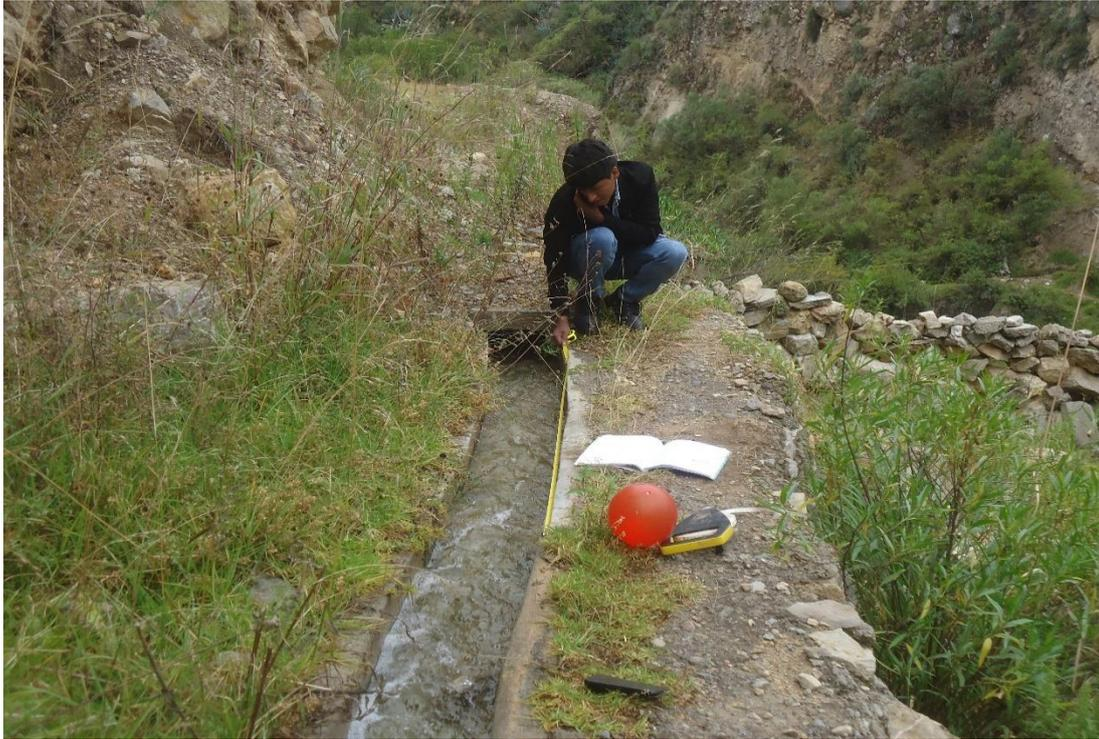
*Figura 40.* Canal de riego Potrero - Medición de Caudal.
