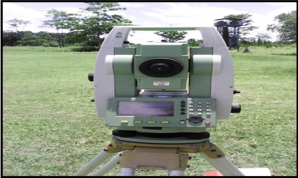
Fotografía 01: Estación total utilizada para el levantamiento topográfico.
