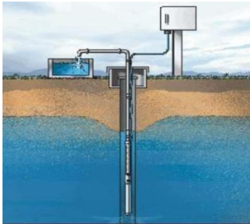
Figura 04: Captación de agua subterránea
