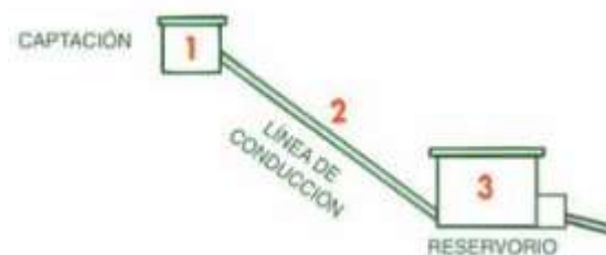
Imagen 8: Línea de conducción
