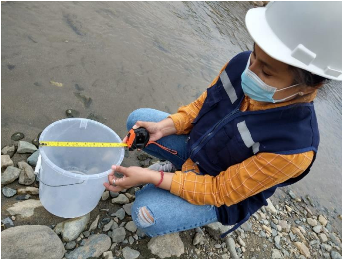
Gráfico 42: Caudal aforado del manantial de laderas.
