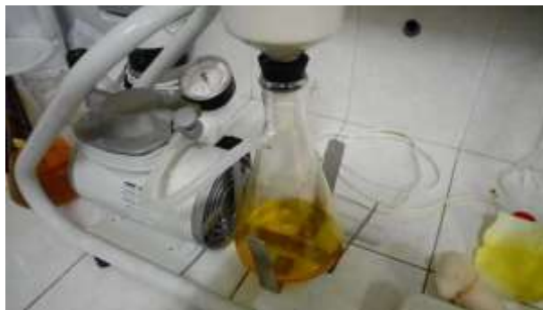
Figura 6: Método de filtración con bomba al vacío para el Zingiber Officinale (Kion) en el laboratorio de Microbiológica de la UNT- Trujillo
