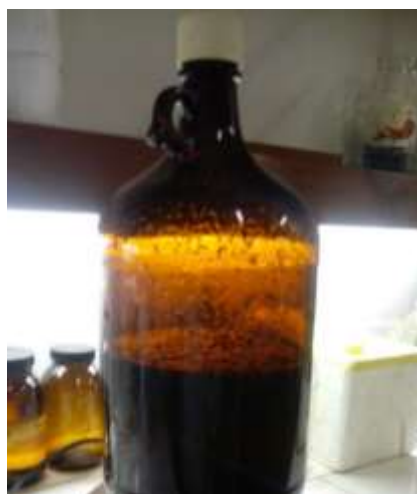
Figura 4: Obtención del macerado etanólico de Zingiber Officinale (Kion) en una damajuana para su posterior almacenamiento durante 7 días.
