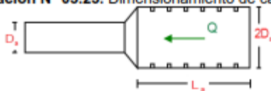
Ilustración N° 03.23. Dimensionamiento de canastilla
