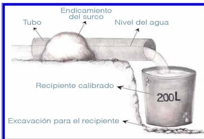
Figura 5. Medición del caudal por el método volumétrico
