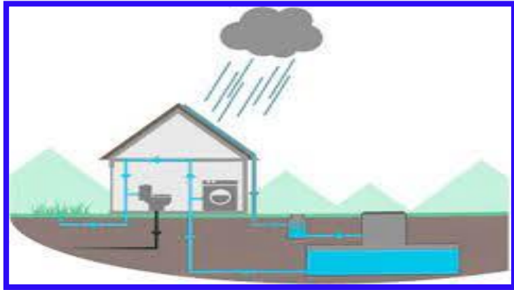
Figura 2. Captación de agua pluvial en vivienda
