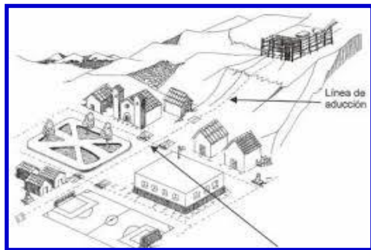
Figura 15. Esquema de una línea de aducción
