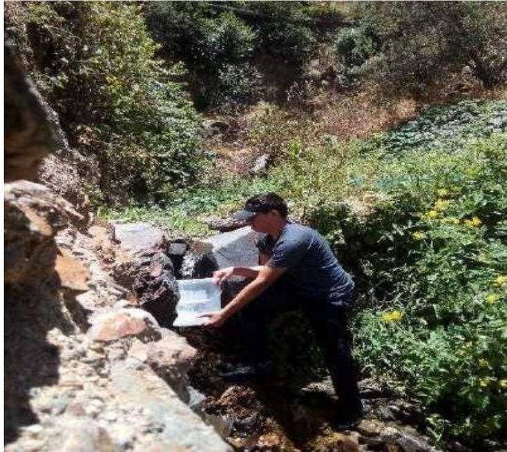
**Fotografía N° 5:** En esta fotografía se realizó la medición del caudal de tipo de fuente manantial de ladera concentrado para el centro poblado Culcubamba.
