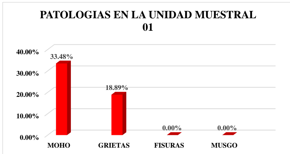
Figura 2. Gráfico de barras de porcentaje de área afectada en la UM-01 Fuente: Elaboración propia
