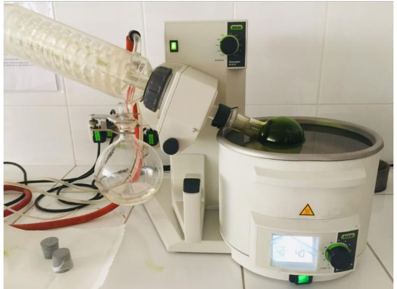
IMAGEN N°10: extracción del extracto hidroalcohólico de las hojas de Foeniculum vulgare Miller – HINOJO mediante rota vapor
