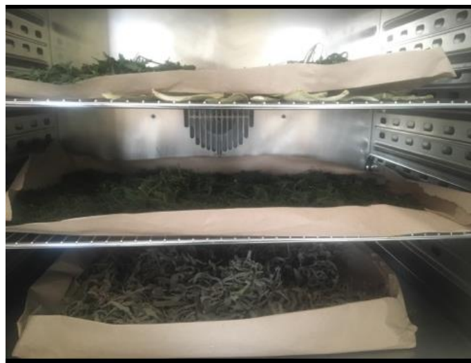
IMAGEN N°04: secado de la planta Foeniculum vulgare Miller – HINOJO estufa modelo BRINDER FD 115 a una temperatura de 40° por 5 horas
