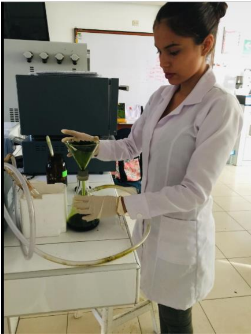
IMAGEN N°09: filtración de la maceración para llevar a rota vapor y extraer el extracto hidroalcohólico de las hojas de Foeniculum vulgare Miller – HINOJO
